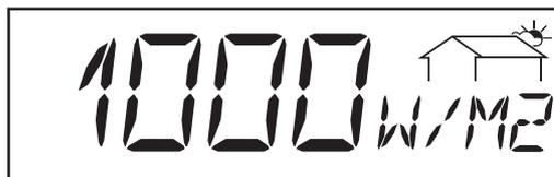
\* **Sonneneinstrahlung** ... pro Quadratmeter auftreffende Einstrahlungsleistung (Watt/m<sup>2</sup>; Option Sensorkarte)
