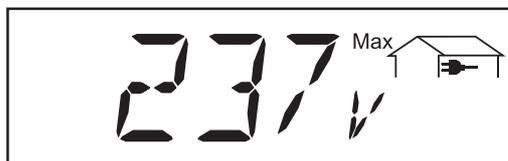
**Netzspannung maximal ...**
