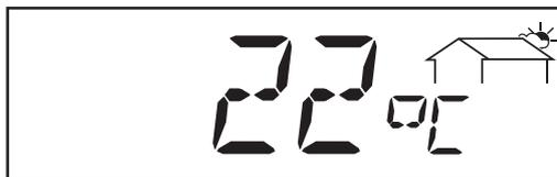
\* **Umgebungstemperatur** (°C; °C; im Setup-Menü auch auf °F einstellbar; Temperatur-Sensor Nr.2; Option Sensorkarte)
